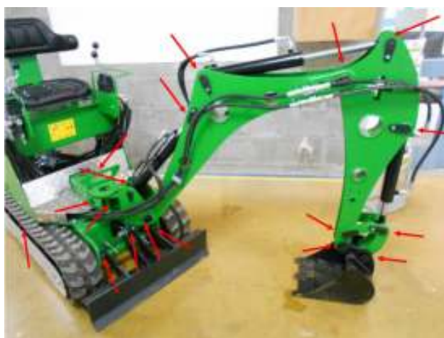
Obr. 9 Mazací body
